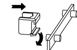
1. Filmscharnier an der Flachstangenführung nach unten öffnen und über der Flachstange positionieren.
