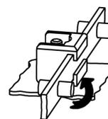
3. Durch Festziehen der Befestigungsmutter schließt das Filmscharnier automatisch und die Flachstange ist gesichert montiert.
