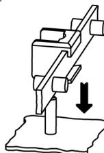
2. Flachstangenführung auf den dafür vorgesehenen Schweißbolzen montieren.
