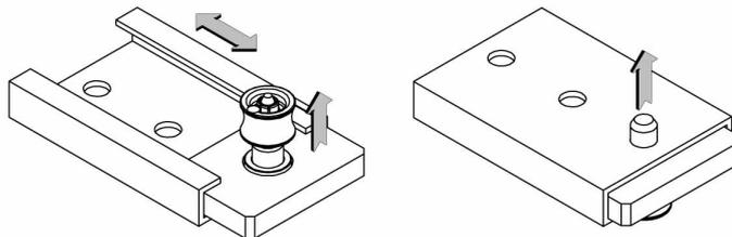
Zum Fixieren oder Lösen wird die federunterstützte Handhabe gezogen bzw. los gelassen.
