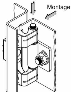
Den Stift bei Montage der Tür wieder einschieben. Er rastet in der Endposition ein.
