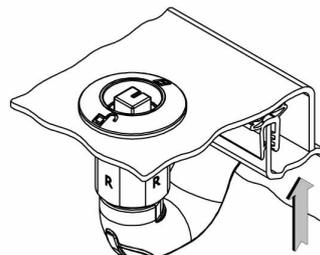
Durch eine weitere 90° Drehung wird die Zunge um 6,5mm gegen die Schließfläche gezogen und damit die Dichtung komprimiert. Die Tür ist spielfrei verriegelt.
