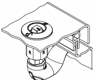
Durch 90° Betätigung Drehung der wird die Zunge hinter die Schließfläche gedreht, die Tür kann nicht mehr geöffnet werden.
