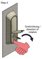
Schwenkgriff gedrückt halten und den Schlüssel nach rechts (Uhrzeigersinn) drehen. Hold swinghandle and turn the key to right (clockwise)
